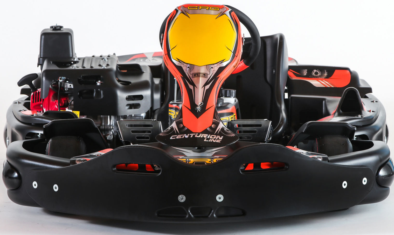
CRG Centurion equipaggiato con motore Honda 390cc da 15 cavalli
